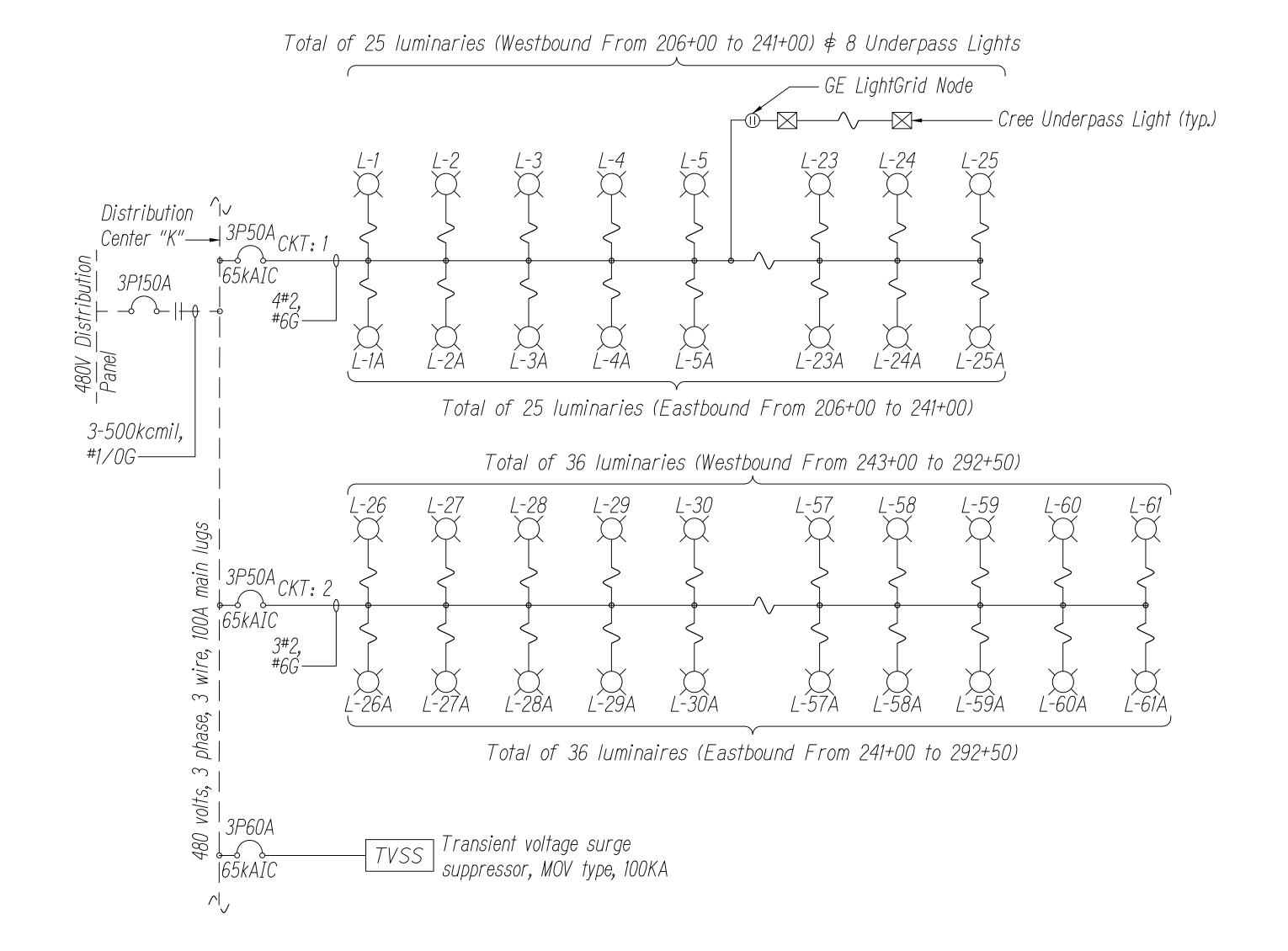
KAISER DISTRIBUTION CENTER - PARTIAL ONE-LINE DIAGRAM (ADDITIVE ALT. #1)
