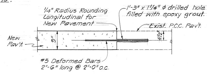
P.C.C. PAVEMENT LONGITUDINAL CONSTRUCTION JOINT (OUTBOUND ONLY) Scale: 1"=1'-0'
