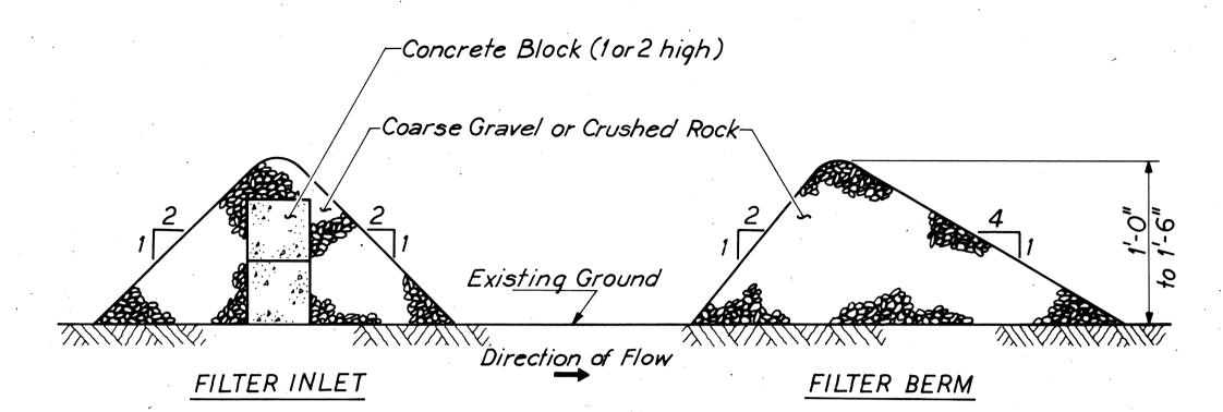
TEMPORARY EROSION CONTROL DETAILS NTS
