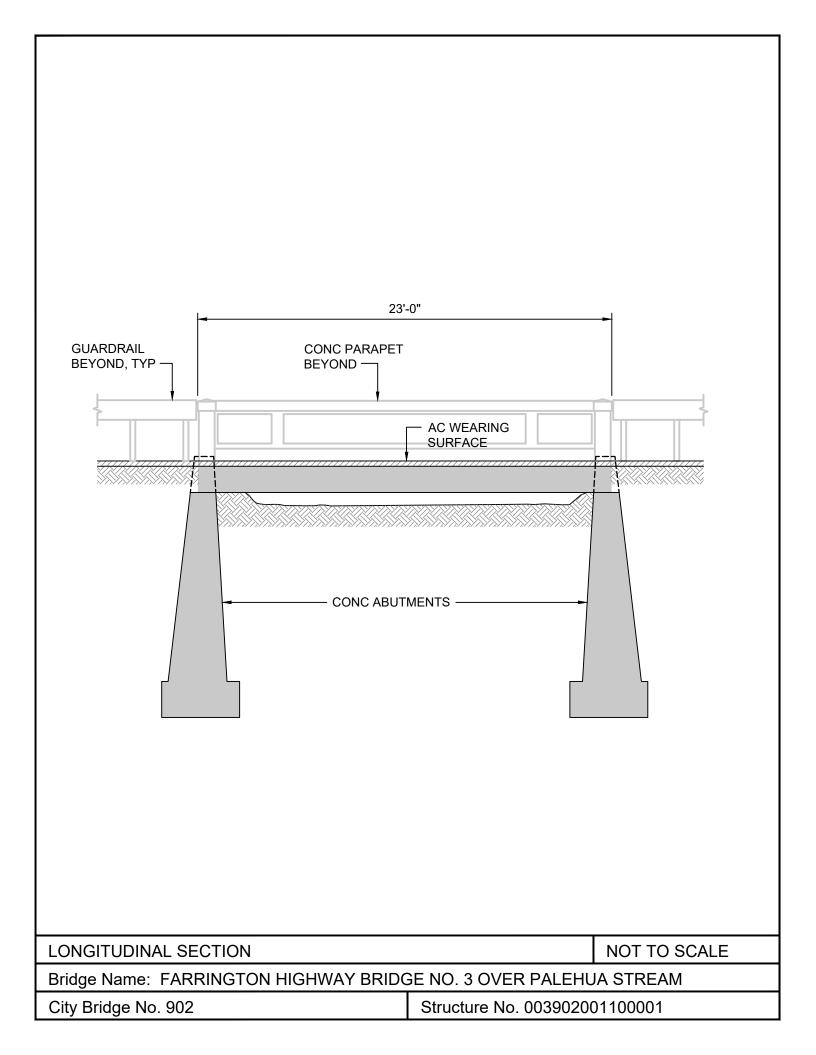
NOTE: UPSTREAM PARAPET HEIGHT = 2'-6" DOWNSTREAM PARAPET HEIGHT = 2'-6" RAILING HEIGHT WAS TAKEN AT AN ARBITRARY LOCATION AND MAY VARY ALONG BRIDGE LENGTH.
