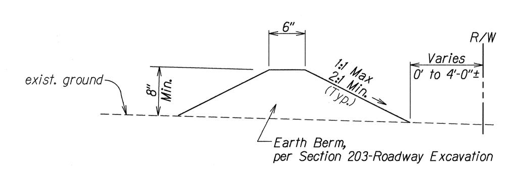
TYPICAL SECTION OF EARTH BERM
