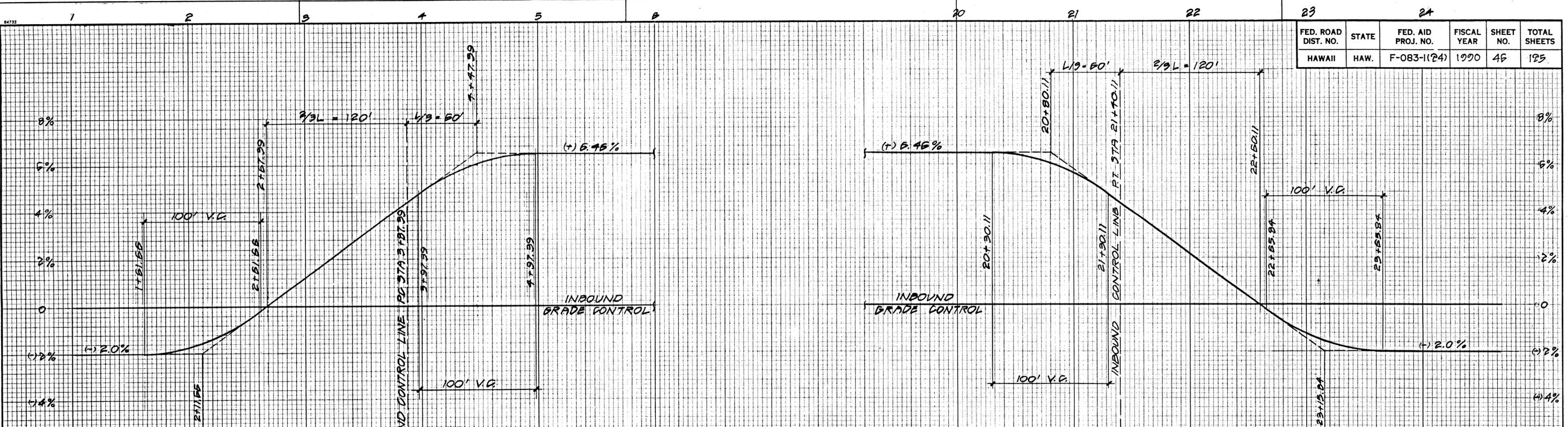
**INBOUND SUPERELEVATION DIAGRAM**
