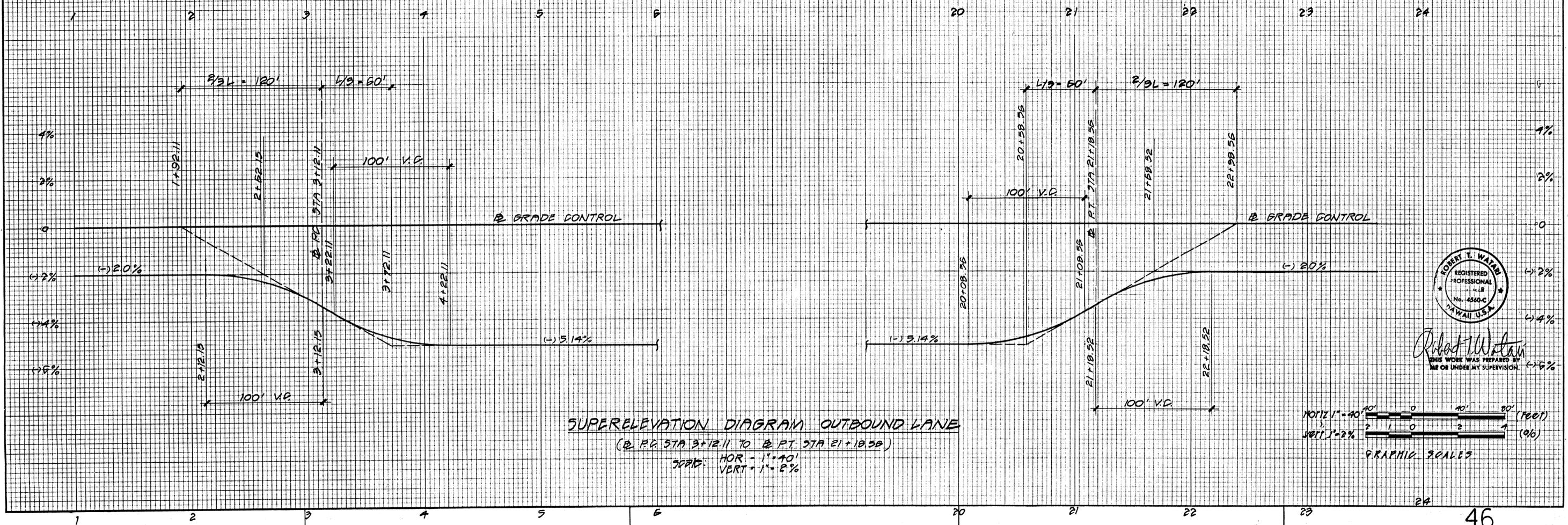
**SUPERELEVATION DIAGRAM OUTBOUND LANE**
