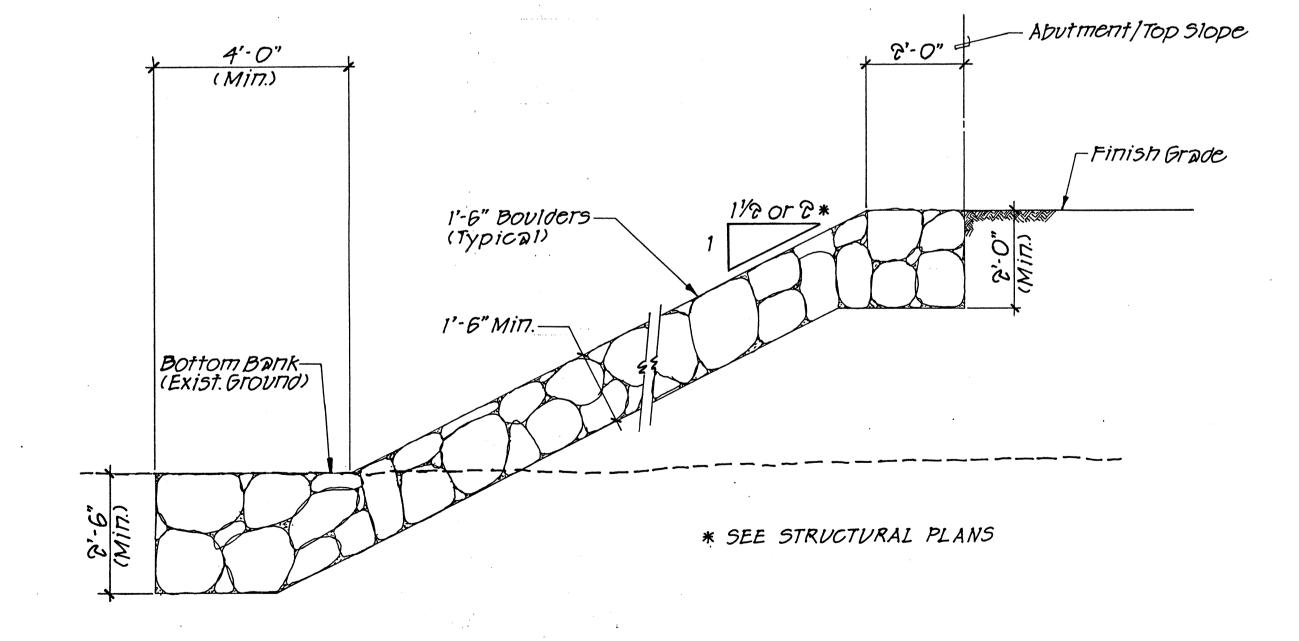
TYPICAL GROUTED RUBBLE PAVING
