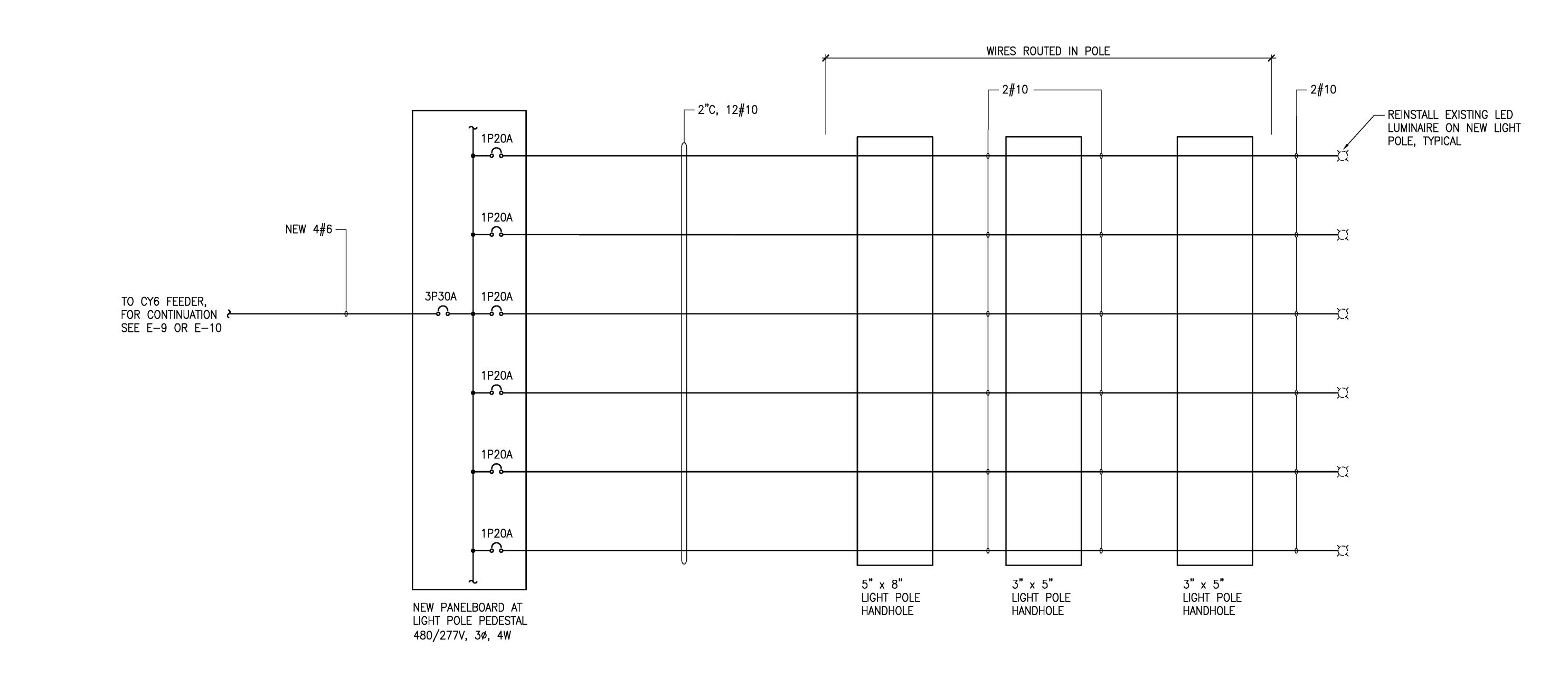
1 TYPICAL LIGHT POLE CONNECTION DIAGRAM E-12 NO SCALE
