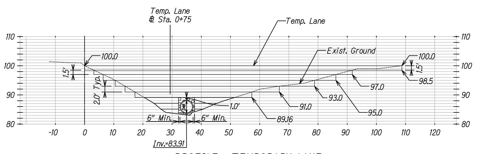
PROFILE - TEMPORARY LANE SECTION C-C Scale: 1"=10'
