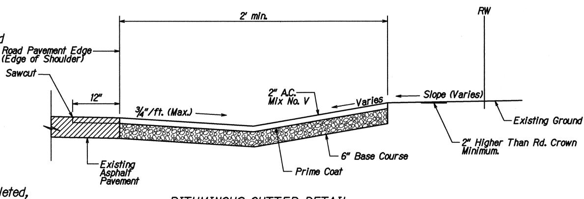
BITUMINOUS GUTTER DETAIL A-A
