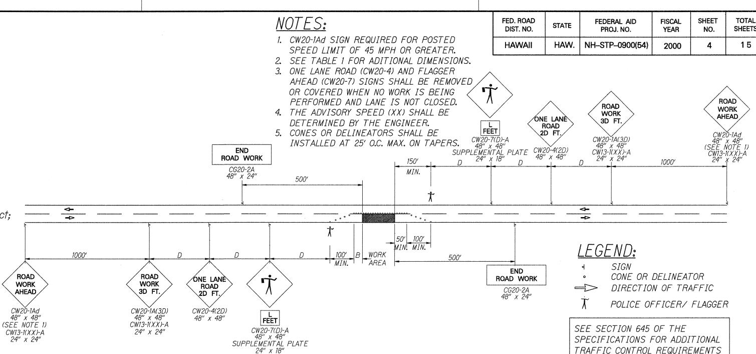
TRAFFIC CONTROL PLAN - TWO LANE HIGHWAY ONE LANE CLOSED
