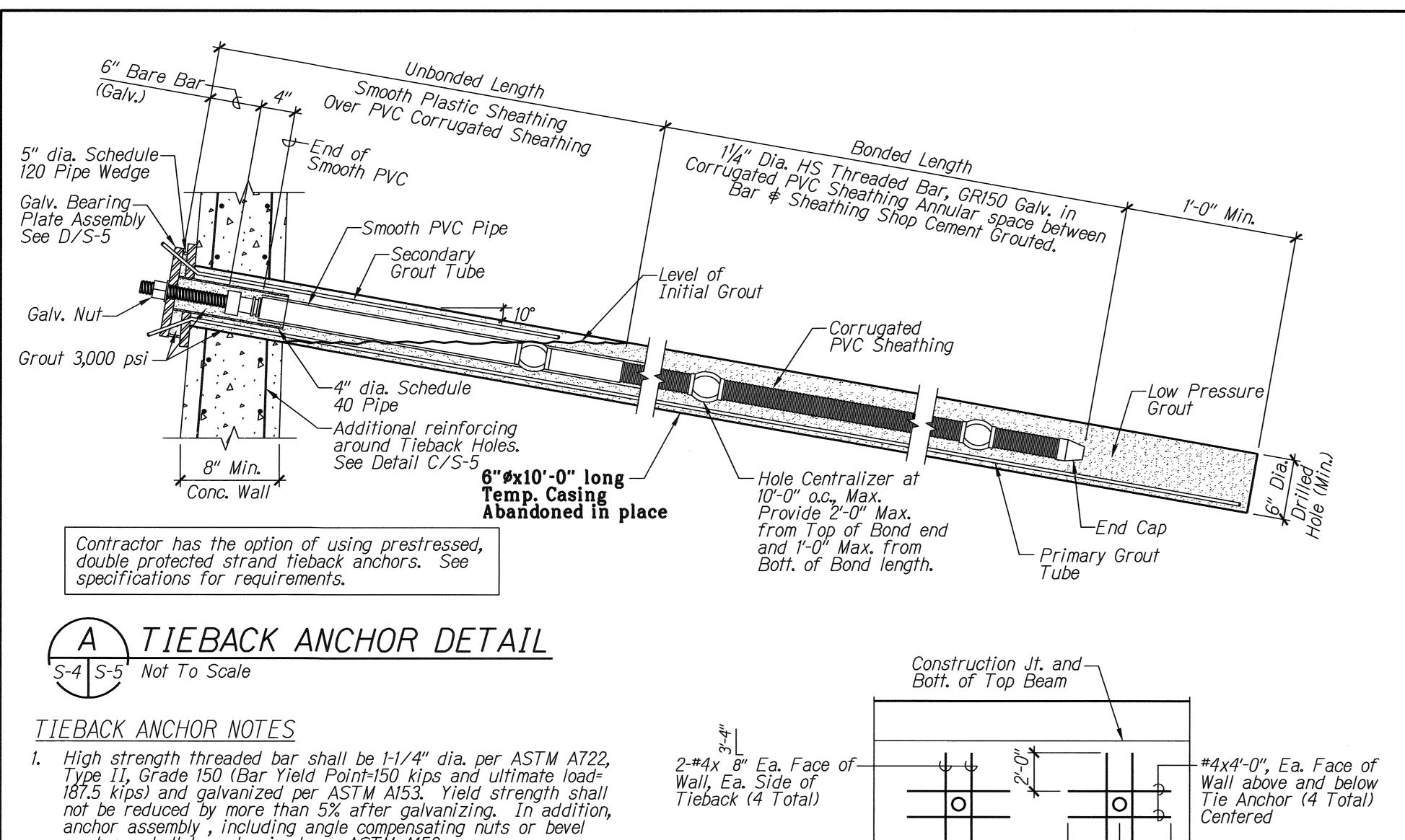
washers shall be galvanized për ASTM A153.
