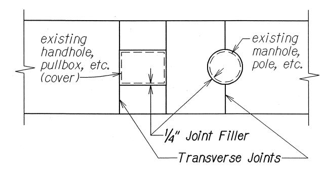
SIDEWALK ISOLATION JOINT DETAIL Not To Scale
