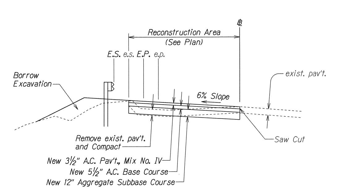
A.C. PAVEMENT RECONSTRUCTION AT 也 STA. 14+75 TO 也 STA. 15+25 Not To Scale
