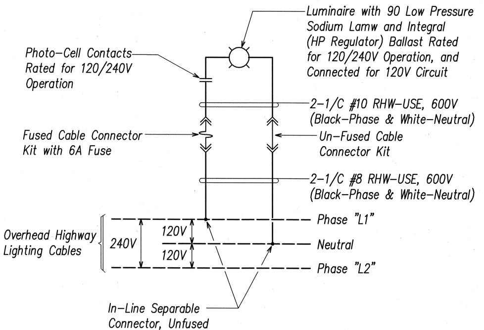
TYPICAL HIGHWAY LIGHT LUMINAIRE CONNECTION DIAGRAM
